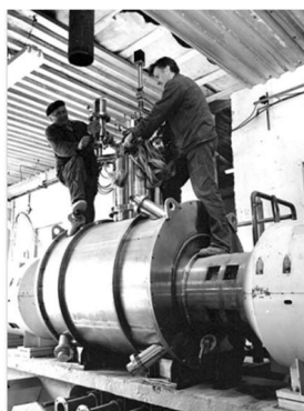
Kryostat československého supravodivého separátoru kaolinu
